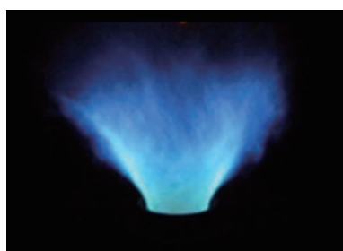
ディーゼルエンジン排気 昇温用小型軽油バーナの開発
