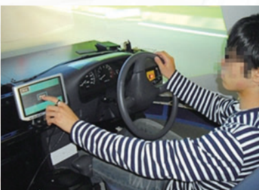
ドライビング・シミュレータを用いた ヒューマン・インタフェース研究
