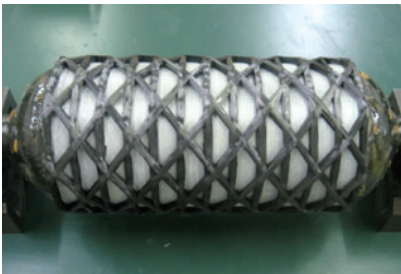
燃料電池自動車用 CFRP 製 グリッド補強容器
