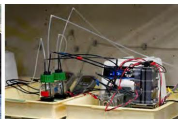
レドックスフロー電池の開発 (工藤祐輔)
