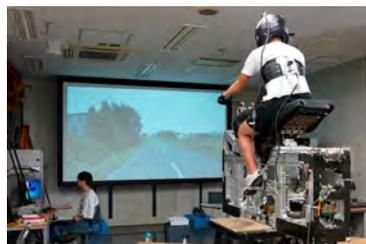
6軸動揺装置を用いた振動場におけるライダーモデル構築 (渡辺淳士)
